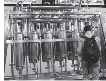
LETZNER社製の製薬業界向け小型廃液濃縮装置
