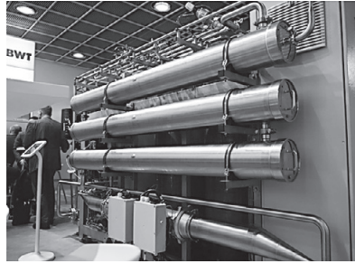
BWT社製の小型廃液濃縮装置 RO膜装置 + 蒸発缶
