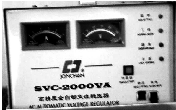
写真5 自前で自動AC制御変圧器を設置
